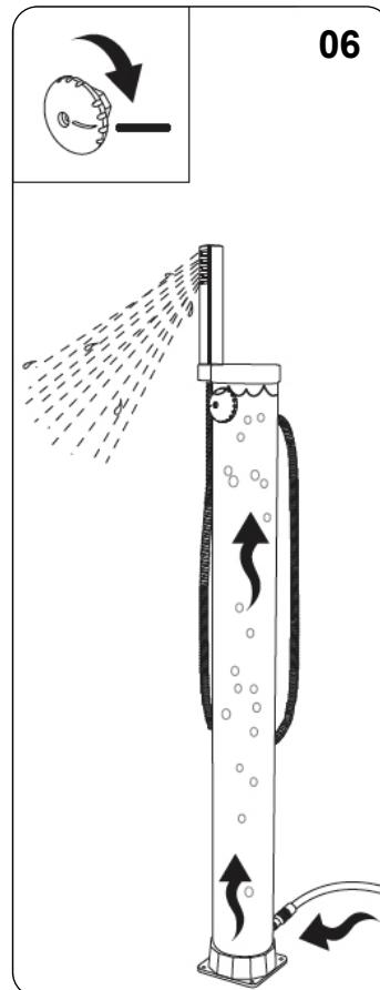
3. Når det begynner å renne vann ut av dusjhodet, skal armaturen på soldusjen stenges. Når armaturen står i CLOSED-stilling, begynner vannoppvarmingen i dusjrøret.
