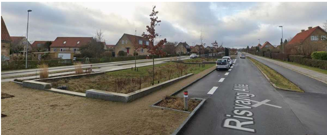
Eksempel fra Århus hvor håndteringen af vand er integreret i vejens design.
